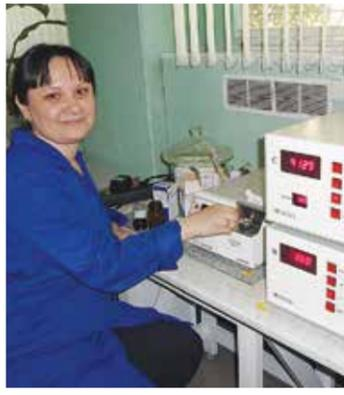
Экспресс-анализатор «АУС» определяет процентное содержание углерода и серы в металлах. В комплект прибора входит корректор массы, который является средством измерения второго класса точности. — Четыре знака после запятой, — подтверждает начальник химико-спектральной лаборатории Венера Валиуллина. — Обеспечивает качественную выдачу анализа.
