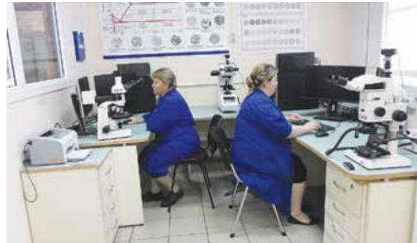
В микроскопной у каждого прибора — своя специализация, каждый рассчитан на выполнение определённого вида исследований. Экспресс-анализы занимают на микроскопе AxioScore. А вот для арбитражных анализов и рекламационных исследований отведён отдельный уголок, оснащённый микроскопом, микротвердомером и стереомикроскопом с программным обеспечением
