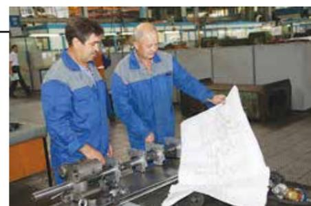
Изготовленное опытными работниками Юрием Казанцевым и Рашитом Насибуллиным приспособление полностью соответствует чертежу
