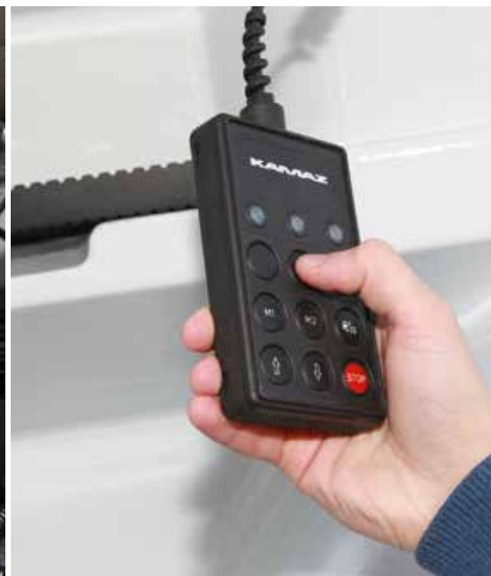
Пульт управления задней пневмоподвеской с кабины
