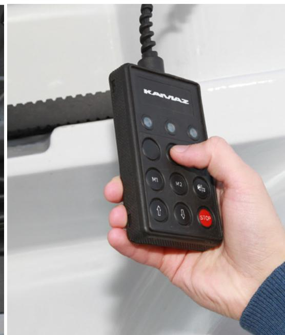
Пульт управления задней пневмоподвеской с кабины
